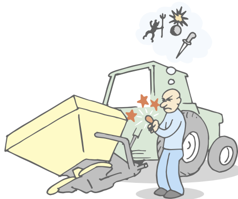
Bild 8. Klämrisk. Vid till- och fränkoppling av redskap är skaderisken hög.
