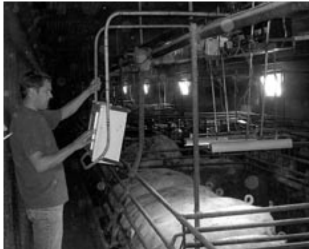
Bild 4 a och b. Vagnen flyttas runt. Den optiska grisvågen kan vara vagnsburen så att den skjuts i fodergången (till vänster), eller rälsburen på skenor i taket (nedan).
