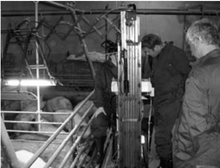
Bild 4 a och b. Vagnen flyttas runt. Den optiska grisvågen kan vara vagnsburen så att den skjuts i fodergången (till vänster), eller rälsburen på skenor i taket (nedan).
