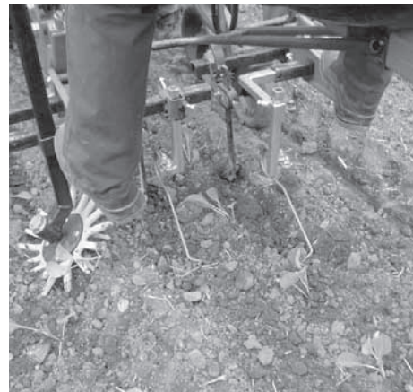
Bild 8. Skillnad i jordstruktur. Skrappinnar som arbetar i planterad kål. Notera skillnaden i jordstruktur och plantbehandling mellan skrappinnarna och fingerhjulen.
