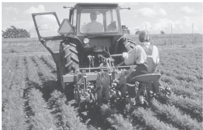
Bild 5. Uppfällda tallrikar. Standardutrustad radrensare för tre rader. Notera att skyddstallrikarna är uppfällda. Vid tidig radrensning används skyddstallrikarna för att minska jordtäckningen i raden.
