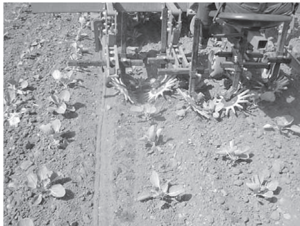
Bild 7. Luckrar upp. Fingerhjul som arbetar i planterad vitkål. Fingerhjulen luckrar upp marken runt plantan bättre än skräppinnarna och är snällare mot plantorna.
