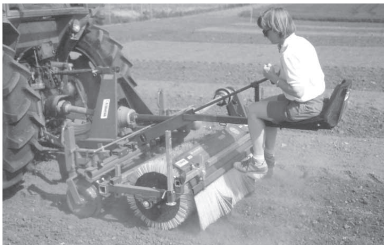
Bild 9. Ovanlig metod. Radborstning med s k Fobro-borste. Metoden är idag ovanlig p g a sin låga avverkningskapacitet och olämpliga arbetsmiljö. Denna teknik har idag ersatts av skrappinnar och fingerhjul.
