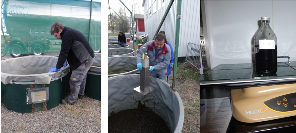
Figur 2. Fyllning av behållare och placering av separata flaskor i stativ i behållarna på halva gödseldjupet, samt i laboratorium vid konstanta temperaturer.
