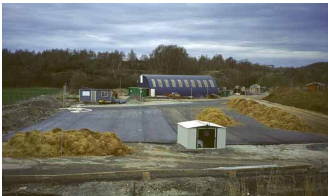
Bild 1. Försöksanläggningen för strängkompostering av hästgödsel, med yta för själva komposteringen till höger samt yta för efterkommande lagring till vänster. Närmast i bild ses mätstationen för lakvattenflöden, inrymd i det ljusa plåtskjulet.
