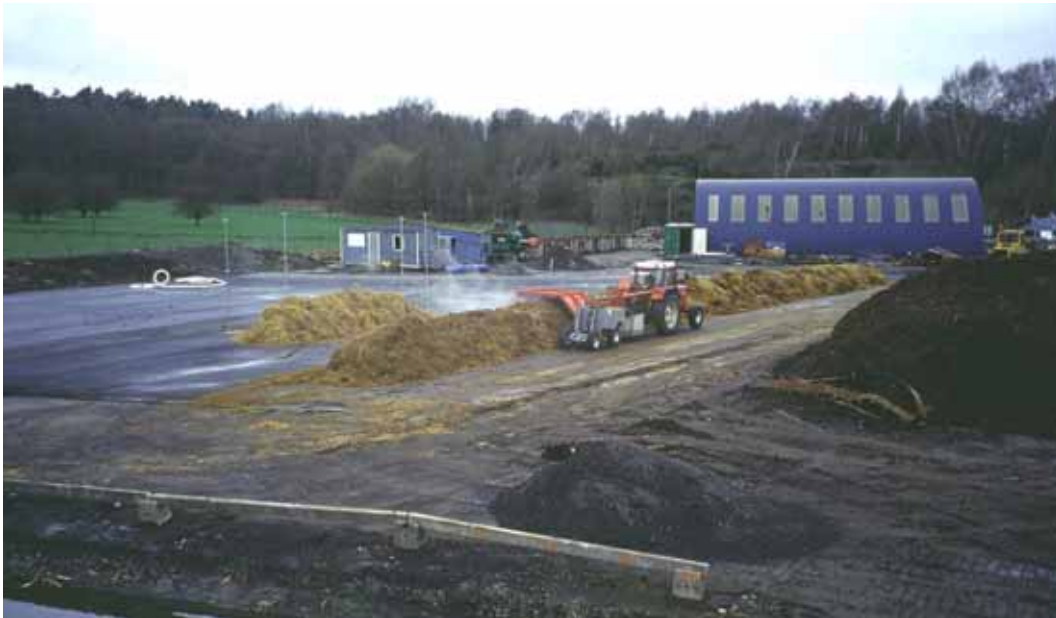
Bild 3. Traktordriven kompostvändare med hydraulmotor driven hjulaxel för anpassad framdrivningshastighet. Axeln är placerad i vändarens bakände och skjuter vändarekipaget framför sig.
