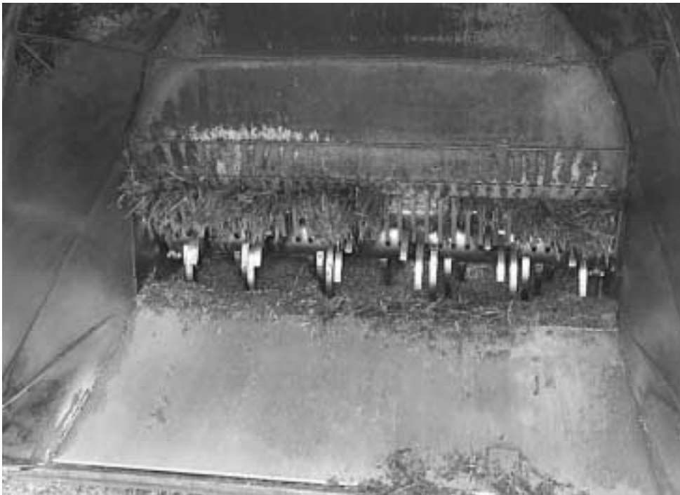
Bild 1. Vid ensilering i slang komprimeras grönmassan i en tunnel bakom maskinen med en kraftig packningsrotor.
