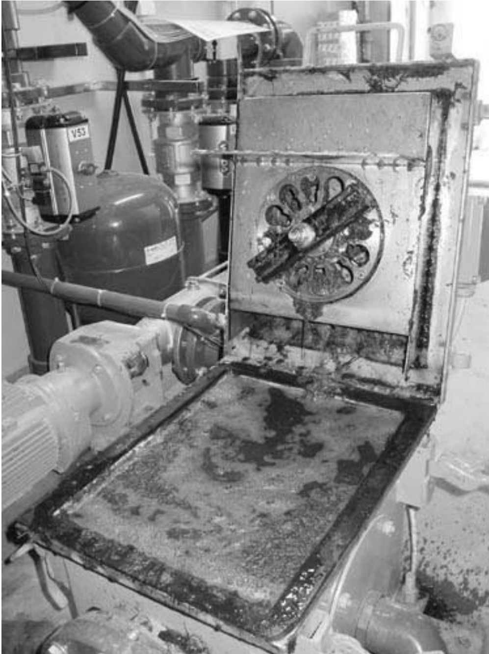
Bild 7. Macerator som har öppnats. I bilden syns den skärande kniven och dess hålskiva. Foto: Mats Edström
