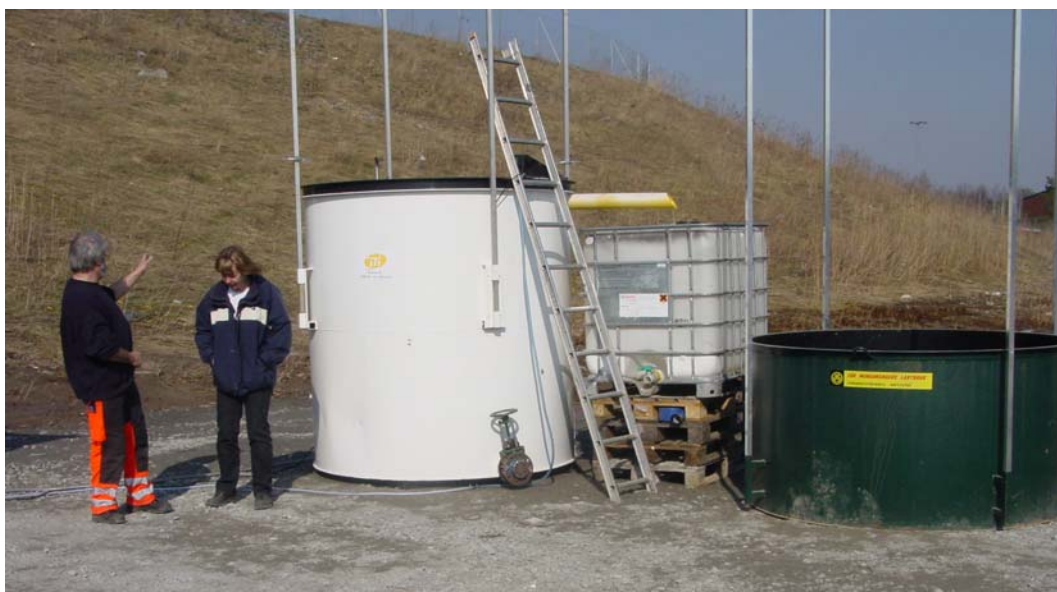
Bild 6. Den vitmålade behållaren med luftare samt den mörkgröna behållaren utan luftning. På masterna placerades provtagare under mätperioderna, vilka fångade upp ammoniaken från lakvattnet samt eventuell bakgrundsexponering.
