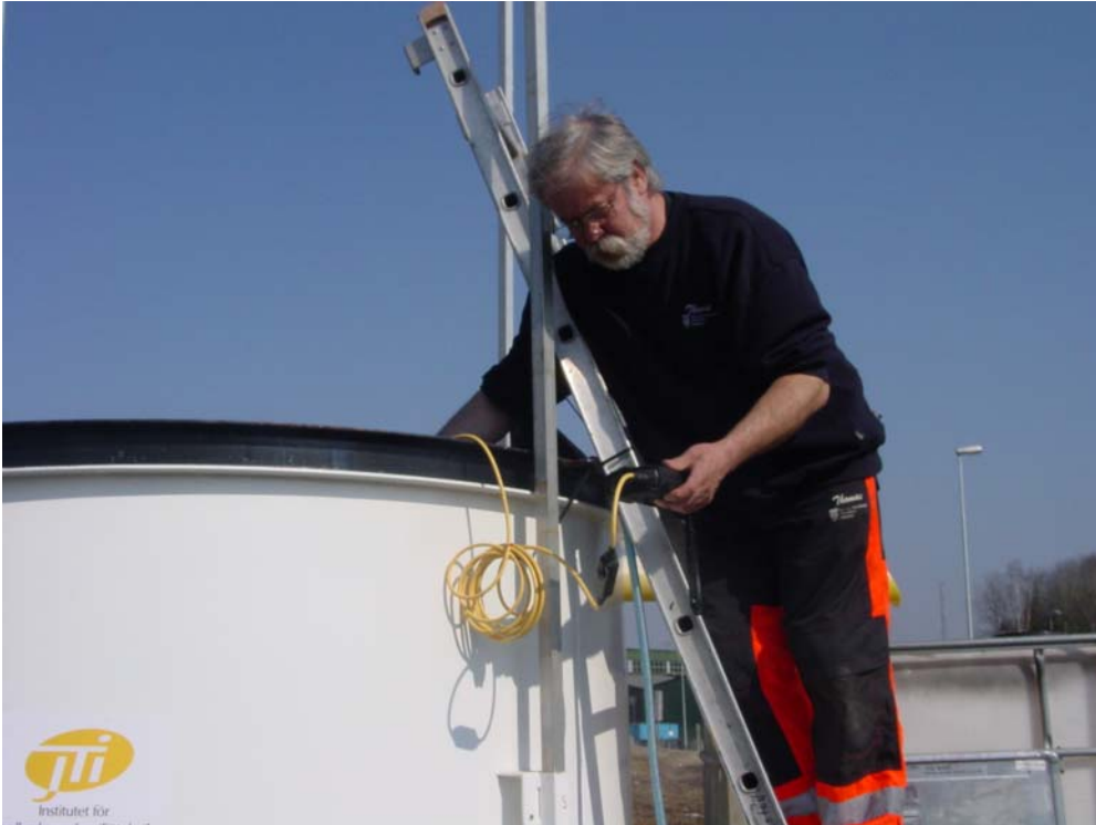
Bild 7. Mätning av syrehalt, pH och temperatur hos lakvattnet i den luftade behållaren.
