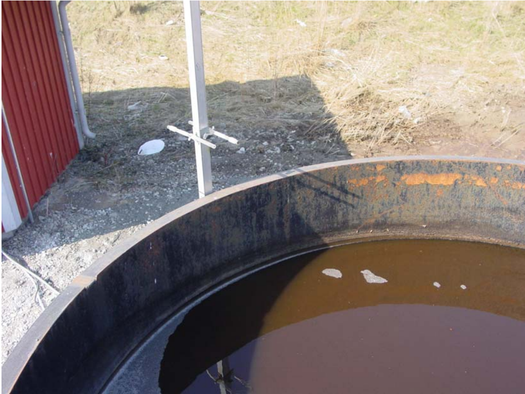
Bild 8. Parvisa passiva fluxprovtagare för mätning av ammoniakavgången från lakvatten. Glasrören är invändigt belagda med ett tunt lager oxalsyra som har till uppgift att binda ammoniak i den luft som passerar genom provtagaren under exponeringen. Totalt exponeras 32 stycken provtagare placerade på master runt behållaren på olika höjd under en mätperiod.
