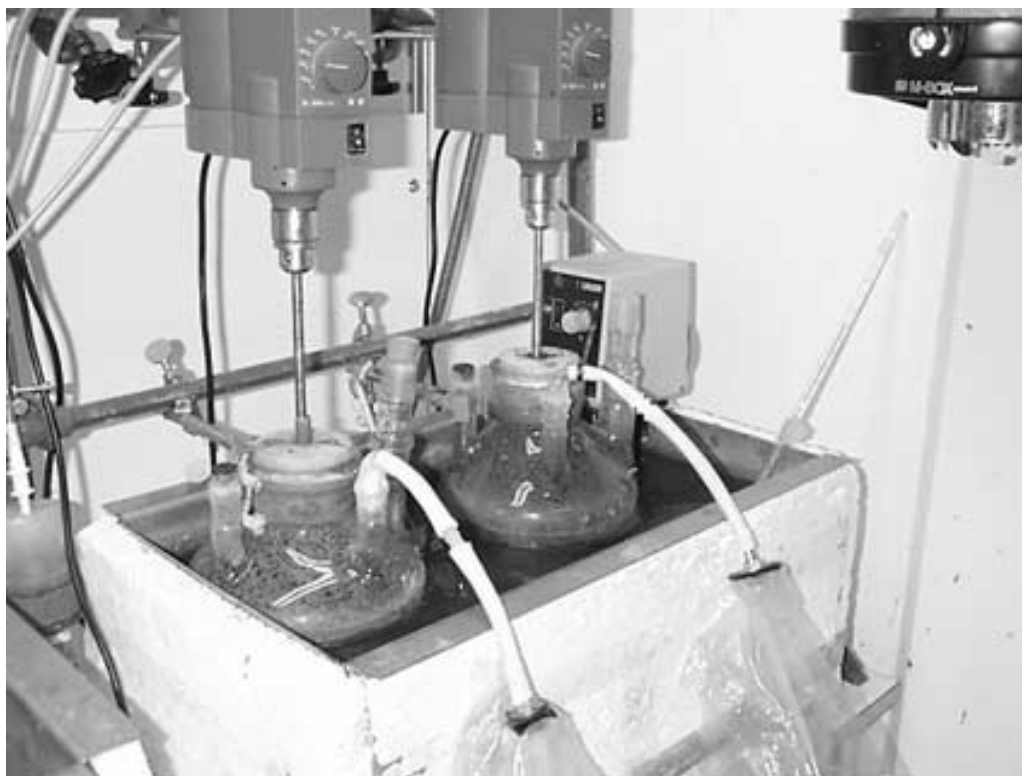
Figur 3. Utrustning för satsvisa utrötningförsök.
