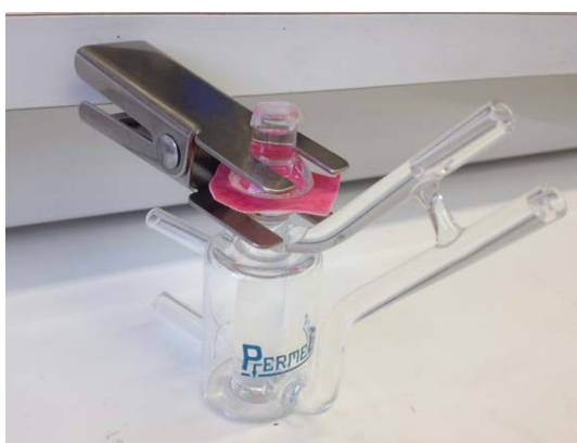
Figur 2. Vänster: Franz-cell för permeationstest monterad med Vileda Style latexhandske. Höger: Schematisk beskrivning av en Franz-cell.
