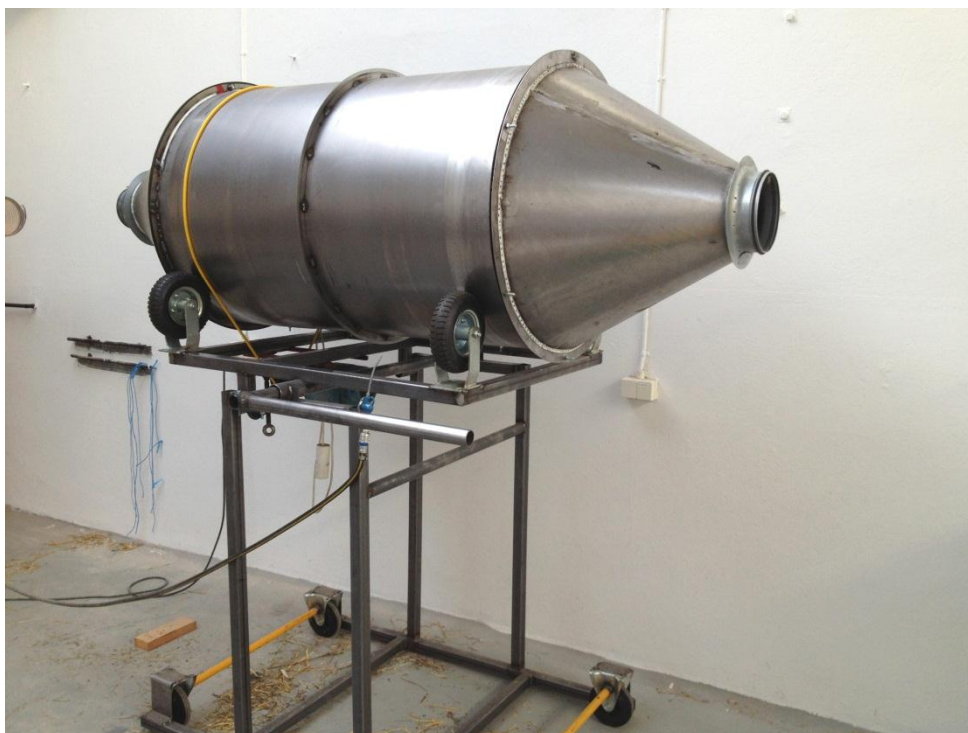
Figur 3. Dammkammare för mätning av mängden luftburet damm och mikroorganismer. Utrustningen är i stort konstruerad som en tät roterande trumma med en invändig medbringare. Foto: Martin Sundberg.
