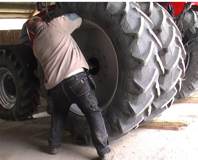
Figur 4. Bilden visar hur lantbrukaren brukar lossa centrumbulten med kofot och bilden är från videofilmen.
