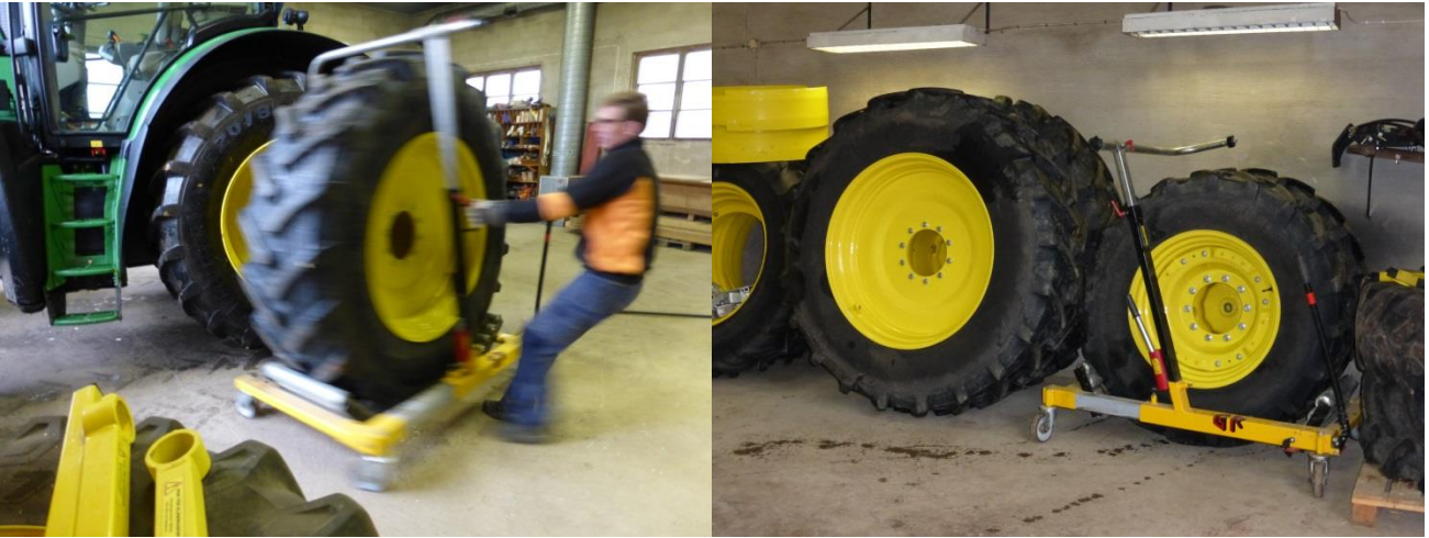
Figur 3. Fotografier som illustrerar hur demontering av dubbelmontage kan gå till med hjulvagn.
