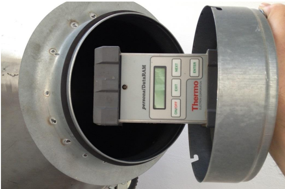
Figur 2. Mätinstrumentet för dammhalt monterades på insidan av ena locket på trumman.
