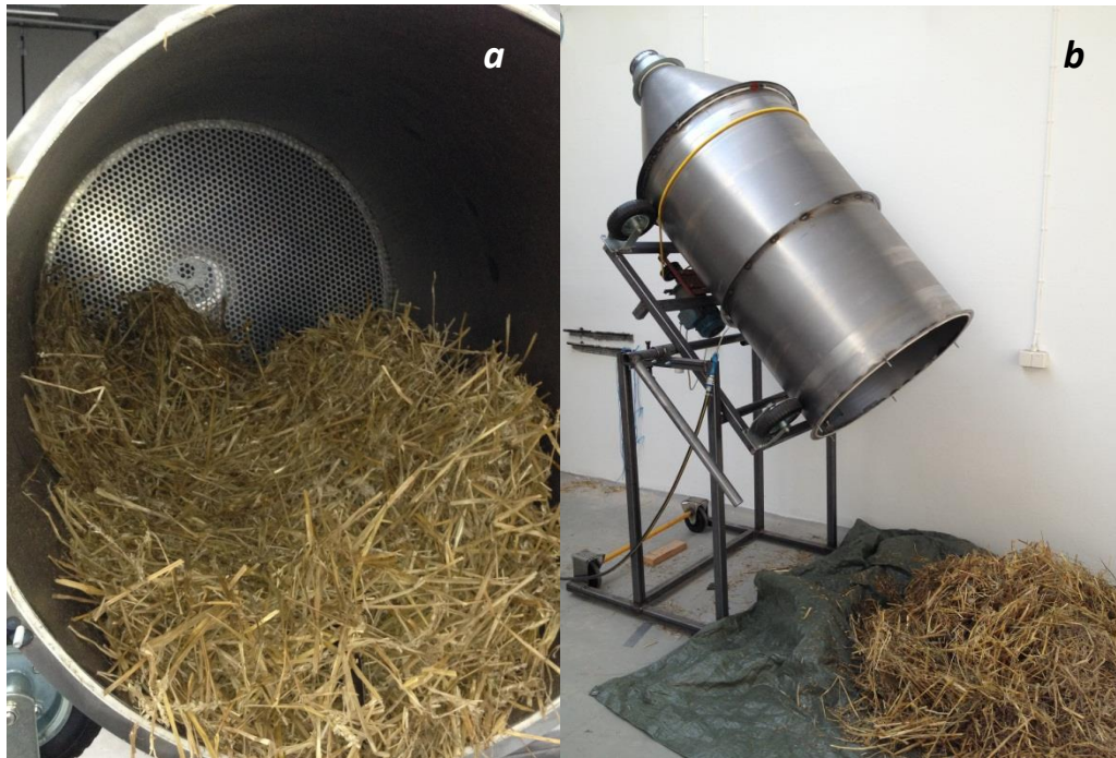
Figur 2. a) Perforerad plåt på sugsidan i trumman. b) Vid tömning tippas hela trumman.
