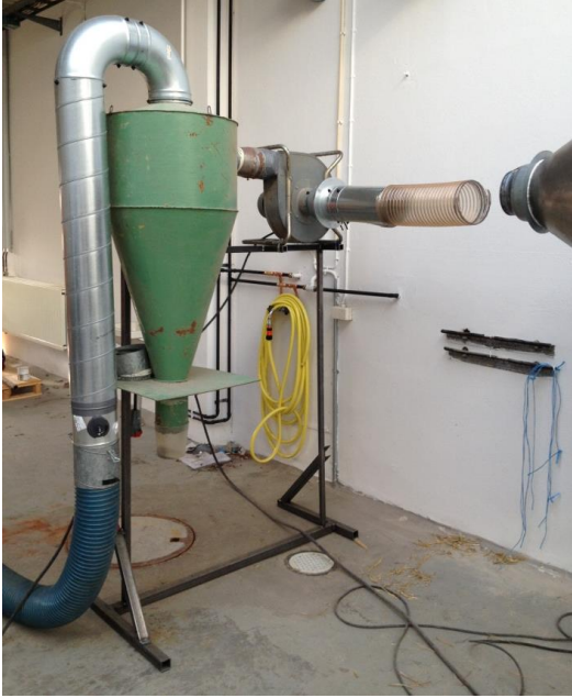
Figur 3. Sugfläkt med anslutning till trumma (här avtagen), samt cyklon.
