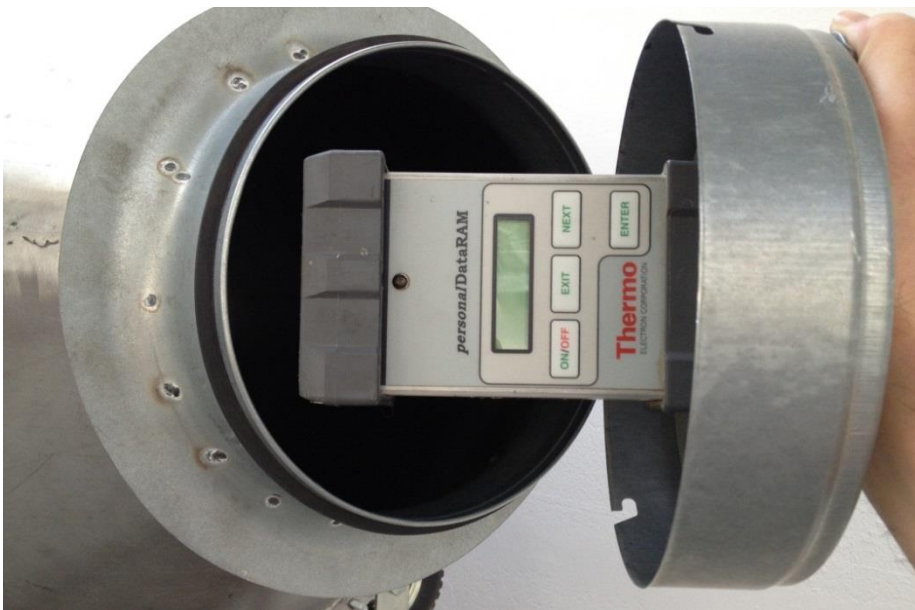
Figur 4. Mätinstrumentet för dammhalt monterades på insidan av ena locket på trumman.
