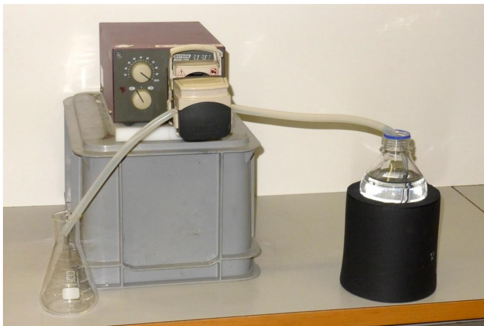
Figur 4. Försöksuppställning vid undersökning av doseringsjämnhet vid pumpning av diskmedel med varierande temperatur. Med en slangpump pumpades det tempererade diskmedlet från flaskan (t.h.) till en mätkolv (t.v.).
