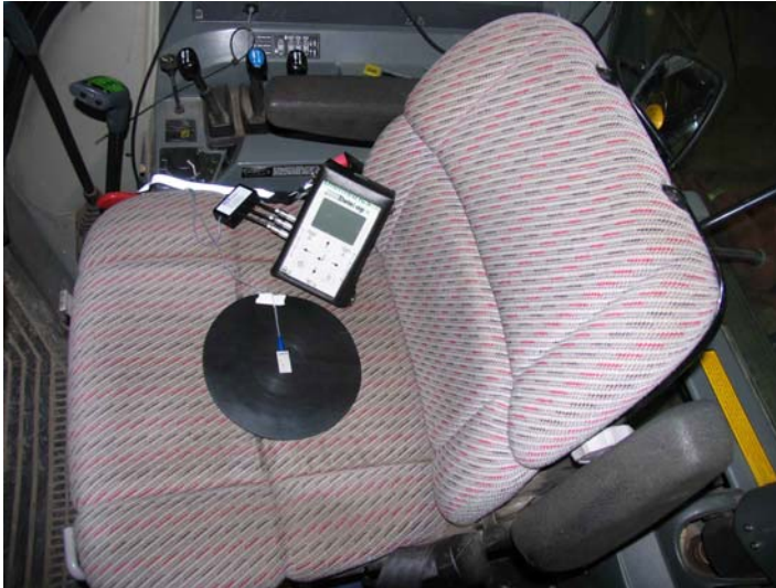
Figur 1. Mätutrustningen placerad i förarstolen på en traktor.
