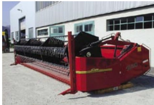
Bild 2. Fast skärbordsförlängning. Detta "rapsbord" av fabrikatet Zürn, är monterat på ett skärbord från Case IH. För att underlätta framkomligheten har skärbordet vertikala sidoknivar vid båda gavlarna.
