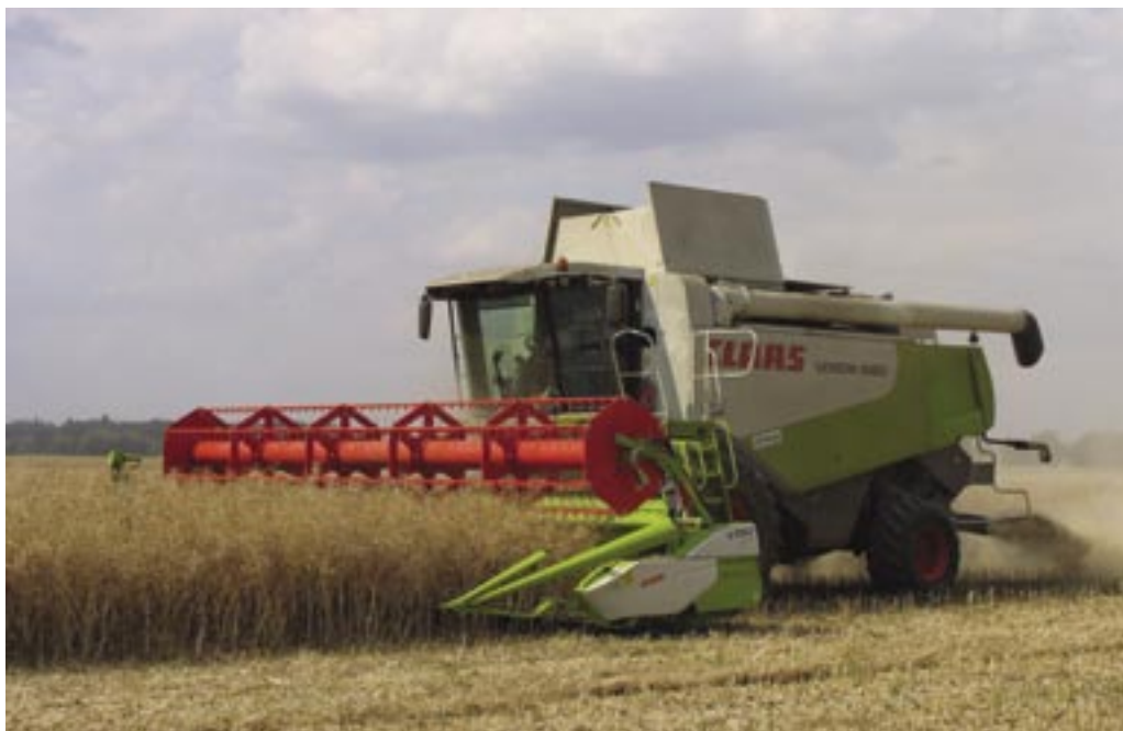
Bild 5. Försök 2006. Fältförsöket genomfördes med skördetröskan Claas Lexion 580 försedd med ett Varioskärbord med skärvidden 25 fot (7,6 meter). Vansta 9 augusti 2006.
