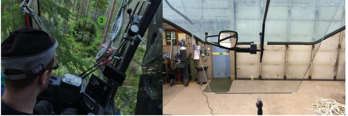
Figur 5. Optea Forest Falcon under användning i skogsmaskin i tidigare projekt (vänster) respektive provuppställningen i traktorhytt i detta projekt (höger).
