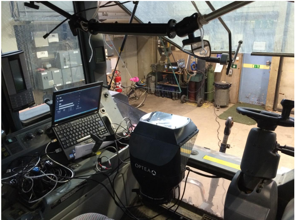
Figur 4. Testuppställning av projektor med tillhörande teknik i hytten hos provtraktorn.
