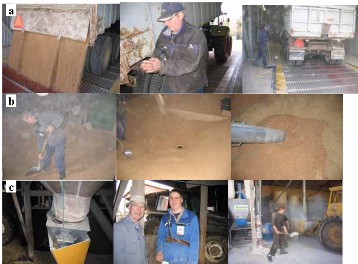
Figur 3. Mätningar i samband med: a) leverans av spannmål till en spannmålsmottagning, b) tömning av ett planbottenlager med golvutlopp på en gård, c) daglig beredning av fullfoder på en gård.
