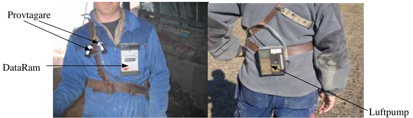
Figur 1. Provtagarnas placering vid exponeringsmätningarna.
