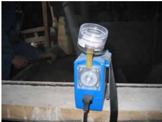
Figur 2. Filterprovtagarens placering vid mätningen av total dammhalt.
