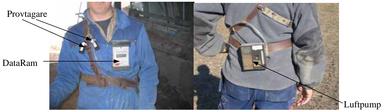
Figur 1. Provtagarnas placering vid exponeringsmätningarna.
