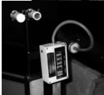
Bild 2. I stallarna placerades mätinstrument för mätning av damm, ammiak, temperatur och luftfuktighet.
