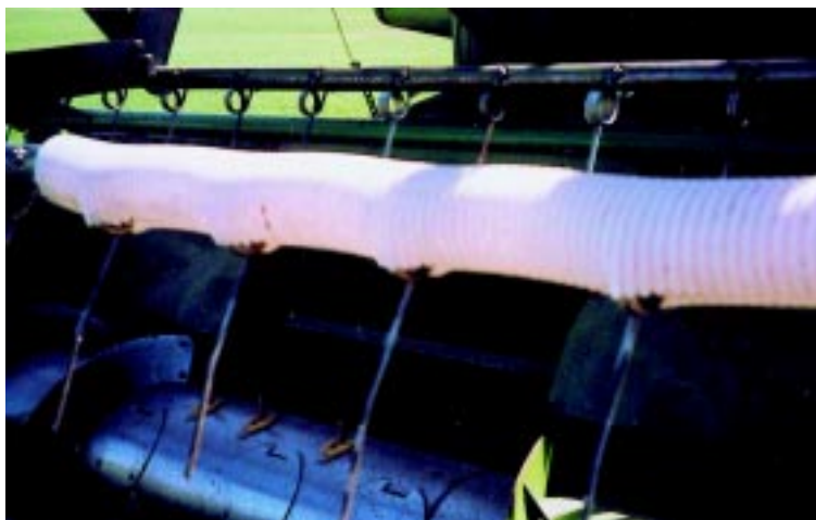
Bild 3. Lindning motverkas genom att fästa plaströr på haspeln (ovan).
