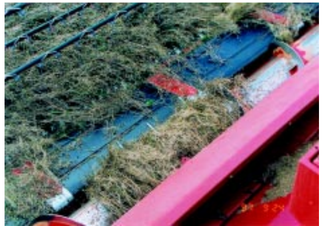
Bild 9. Power-Flow skärbordet från Massey-Ferguson kännetecknas av den bandtransportör som för tröskgodset från kniven till inmatningsskruven. Den lindning av oljelin kring inmatningsskruven, som bilden visar, löstes upp av sig självt då körhastigheten tillfälligt sänktes.
