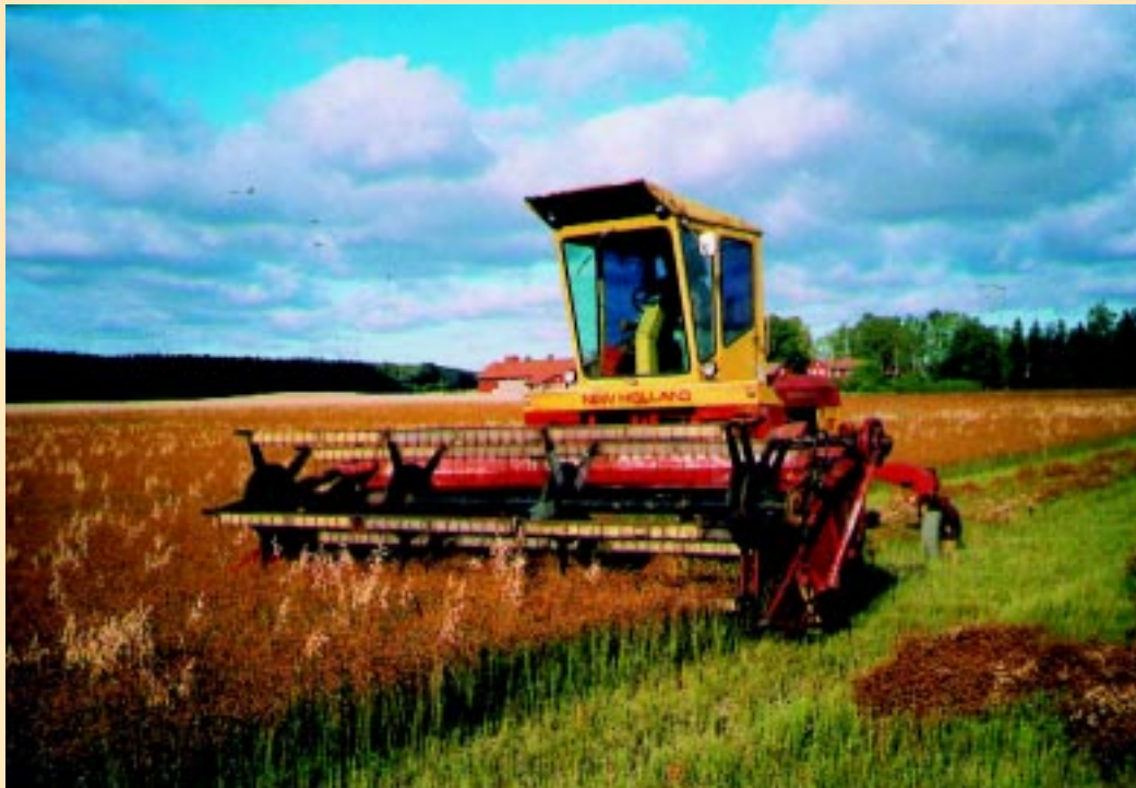
Bild 11. Skärläggning av oljelin. Metoden bör i första hand komma ifråga i de fall man vill få en lingroda att vissna ner utan att använda kemikalier.
