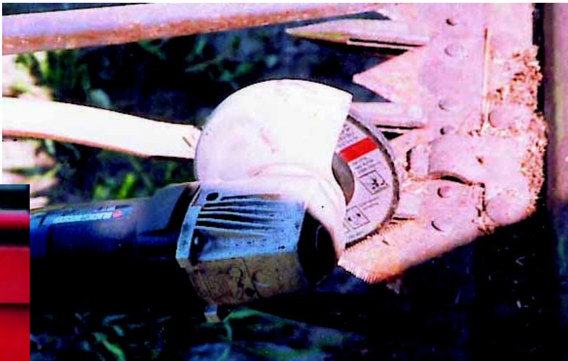
Bild 7 (t.v.). Slipning av skärapparatens fingrar för att åstadkomma bättre avklippning.
