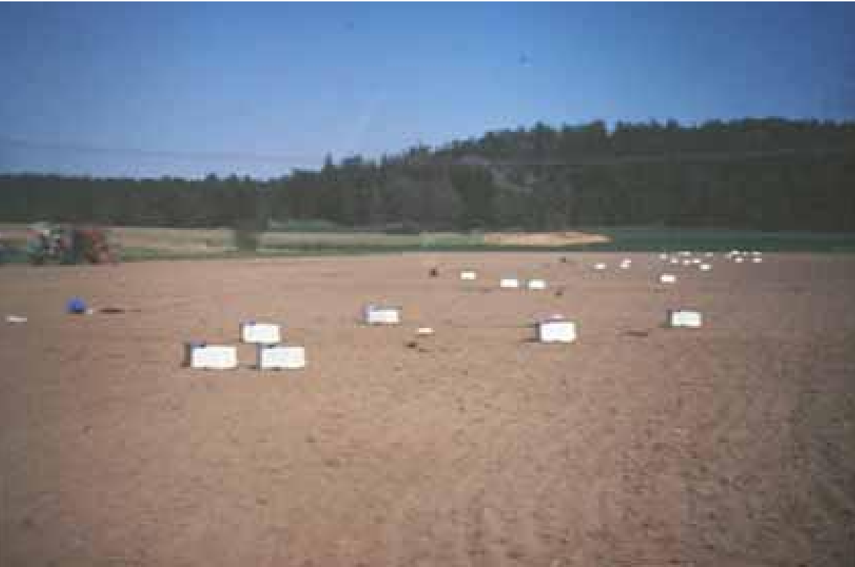
Bild 6. Mätning av ammoniakförluster i vårbruket. Provtagningsutrustningen har placerats ut på fältet direkt efter spridning av gödselmedlet.
