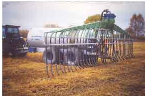
Bild 2. Tankvagn med ramp med släpplangar. Fördelningen av gödseln till slangarna sker vanligen via en centralt placerad fördelare.
