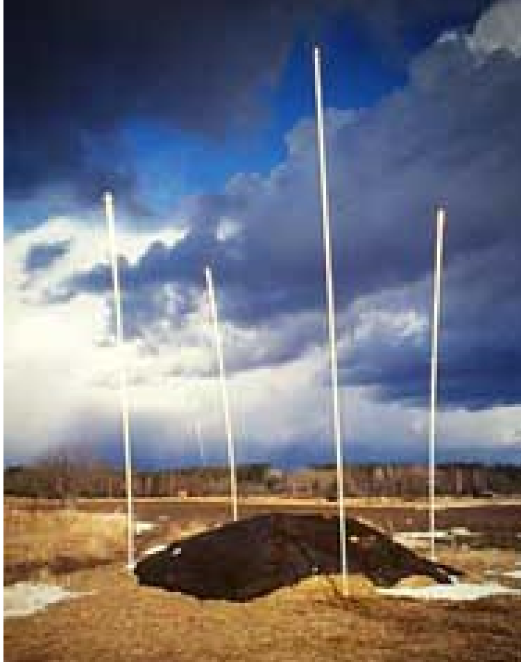
Bild 2. Ammoniakavgången mäts under lagring vid JTI:s fältförsök. Med fyra master runt den halmtäckta gödselhögen, med nät, kan mätning ske oavsett vindriktning.
