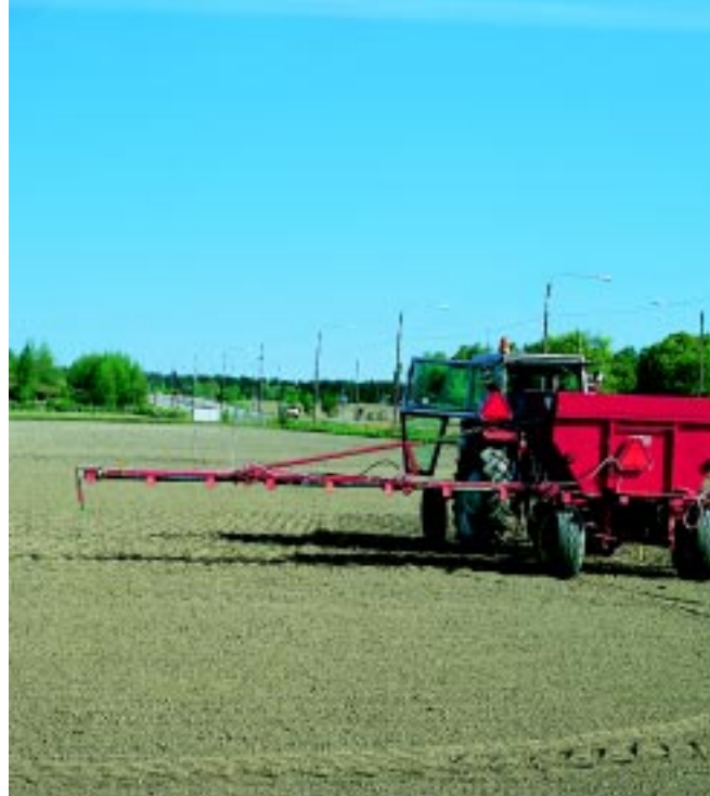
Bild 4. Vid spridning av gödsel pellets användes en bogserad rampspridare under JTI:s försök. Vridprov visade att det inte gick att få önskad giva i enbart en körning, utan rutorna fick övergödas flera gånger.
