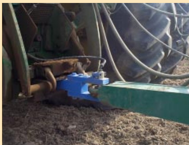
Bild 8. Dragkraftsensorn placeras mellan traktor och harv.
