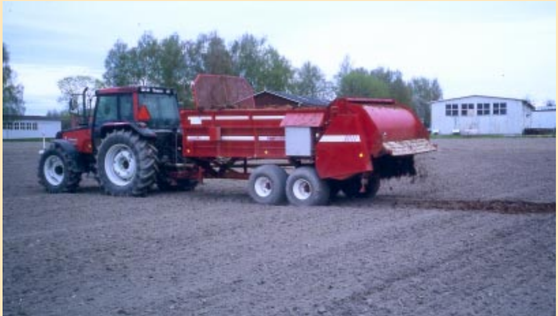
Bild 7. Fältförsöket visade att spridningsjämnheten påverkades relativt mycket vid spridning av låga givor djupströgödsel (mindre än 10 ton per hektar), med en spridarteknik som bygger på liggande spridarvalsar. Detta överensstämmer med tidigare studier som fann att det finns bättre möjligheter att ställa in och kontrollera givan med stående spridarvalsar som spridningsaggregat. Fördelen med försöks-spridarens avskärmade, liggande valsar (se bild ovan) var att man hade en väldefinierad arbetsbredd som tillät begränsad försöksrutestorlek utan att för den skull riskera påverkan på intilliggande rutor.
