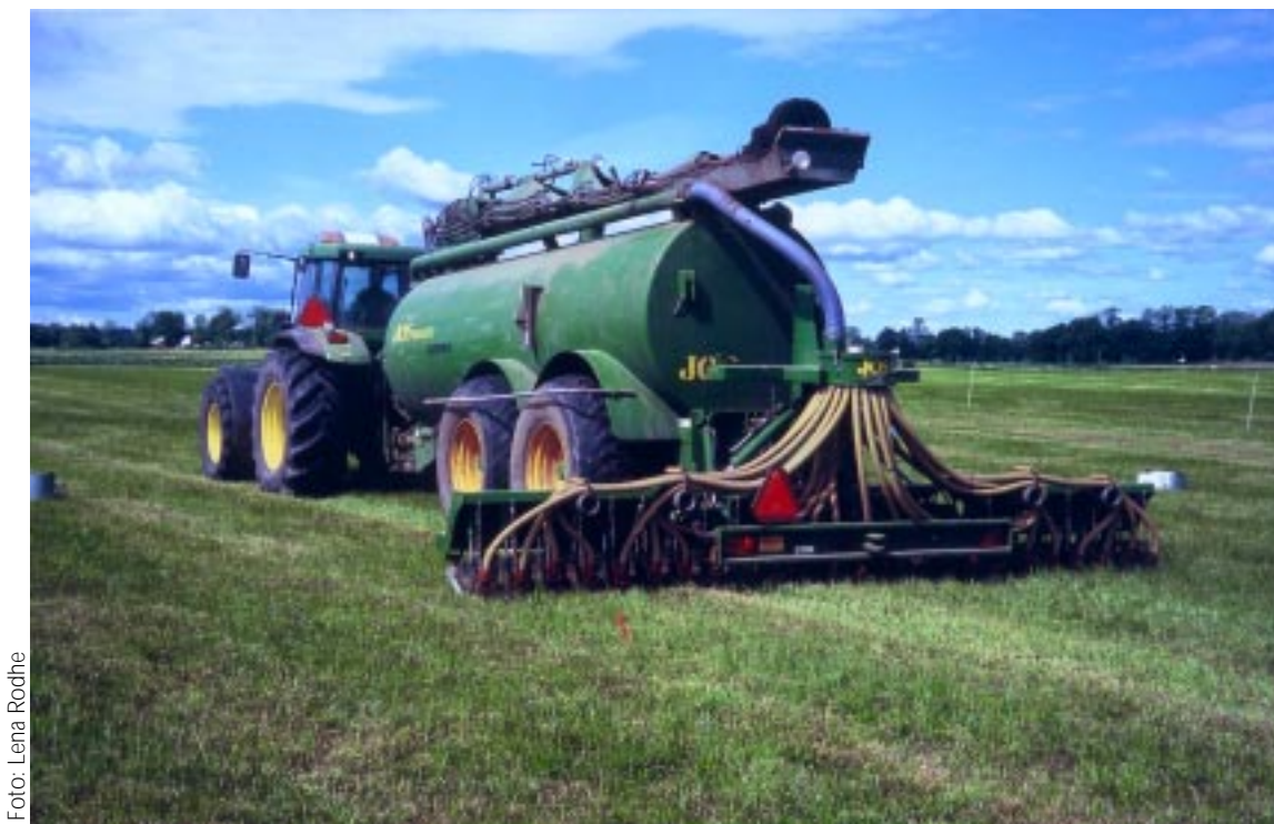
Bild 8. Öppen ytmyllning av flytgödsel i vall. Billarna består av två vinkelställda skivor.
