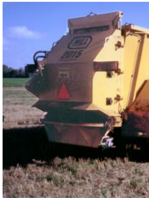
Bild 5. Tvåstegspridare för fast- och kletgödsel och två skålade, roterande tallrikar. Utmatningsskruv
