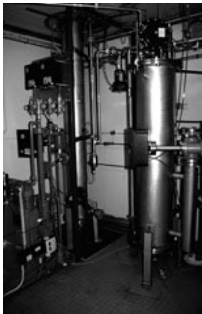
Bild 8. Uppgradering av biogas till fordonsbränsle på Nynäs gård. Biogasens innehåll av koldioxid minskar m h a en vattenskrubber
