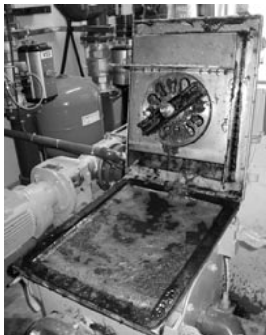
Bild 6. Sönderdelning. En sk macerator har öppnats. Här kan fiberrikt substrat sönderdelas. I bilden syns den skärande kniven och dess hålskiva.
