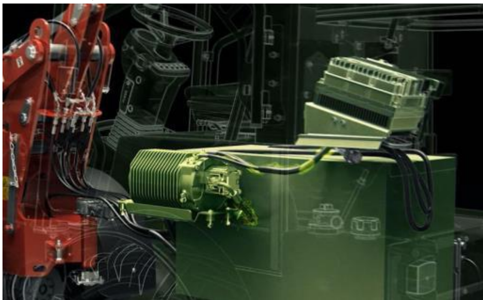
Figur 1: Hydraulsystemets elektriska drivsystem i eHoftrac.
