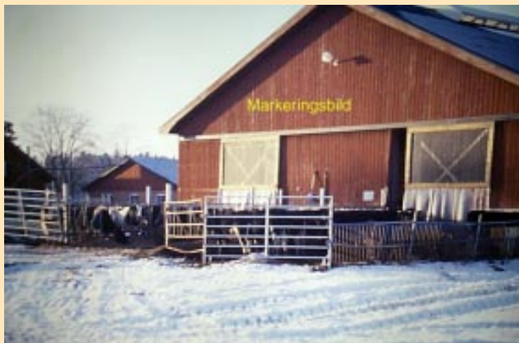
Bild 6. Direktinströmningen av kall luft i ladugård och mjölkgrup kan minskas genom att ha en kraftig plastgardin i dörröppningarna.
